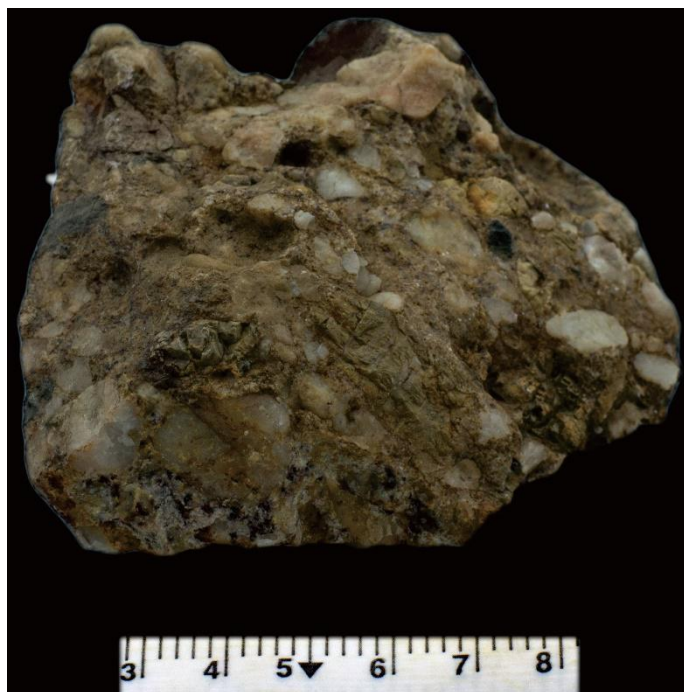
图 3.51 构造角砾岩样品
