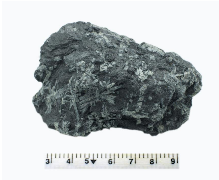
图 3.41 红柱石板岩样品
