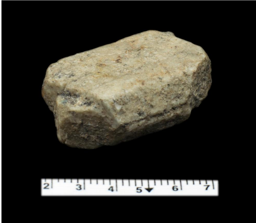
图 2.12 正长石卡斯巴双晶单体样品
