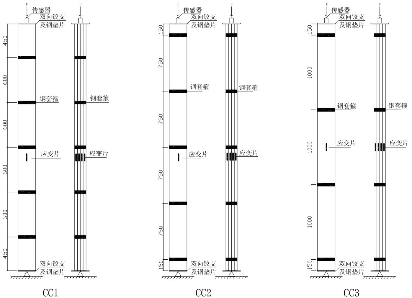
图 3 C 组柱应变片布置示意图
