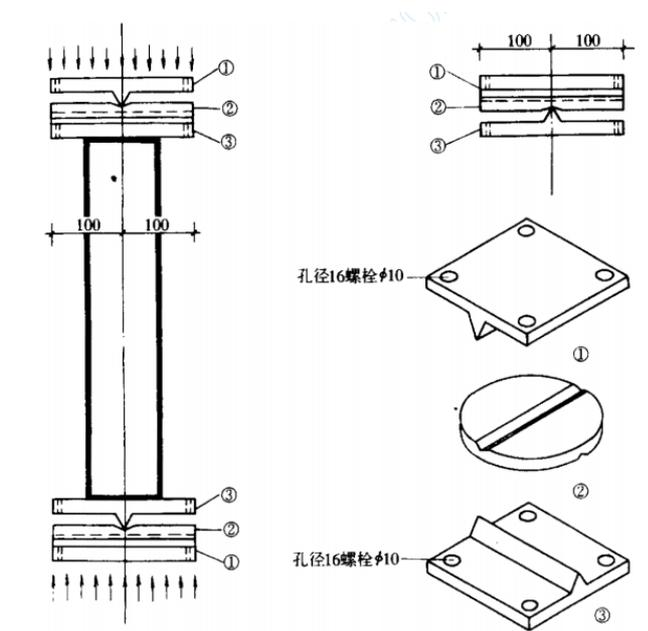
图 1 受压柱两端双向刀铰示意图
