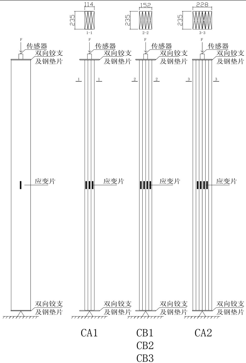
图 2 A 组、B 组柱应变片布置示意图
