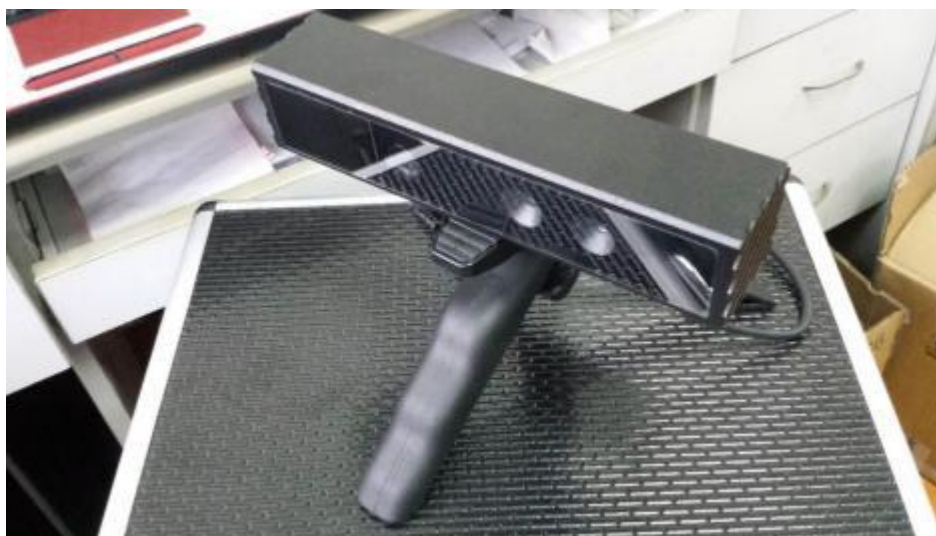
图 5.5 K100 型 3D 扫描仪
