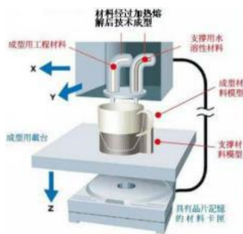
图 5.2 FDM 打印技术原理图
