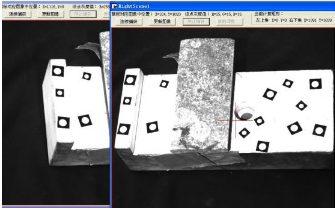
图 4.7 形貌仪采集岩矿表面形态
