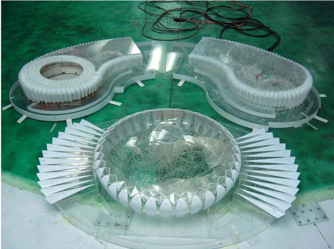
抗风实验室总共包括了4个风洞现在，分别是TJ-1, 2, 3, 4风洞，主要是模拟的大气边界层风洞，即让风洞边界层具有和大气边界层相似的速度和湍流强度分布。TJ-3风洞作为世界上最大的大气边界层模拟风洞，它的试验段尺寸是宽15M，高2M，长14M。TJ-2为一多功能的建筑和汽车模型风洞，TJ-1是直流式边界层风洞。还注意到属于风洞的一些特殊的地方，比如那些用来制造模拟粗糙边界的边界粗糙单元，在TJ-3风洞里看到一般放在来风侧，一个较大的转盘，可以对模型进行360度的风加载。不仅仅有直流风洞如TJ-1还有回流风洞如TJ-3，在TJ-2风洞中一般可以看到可以加天平用来测量五个力学指标，一般是XYZ三个方向力和弯矩共6个指标，老师解释是因为加天平减少了一个。还有幸参加了济南奥体中心项目的风洞试验，真正动手参与其中，模型加工好后的后期局部改造，布线，定位，固定，虽然式一些很普通的事情，但让我还是学到很多东西。
