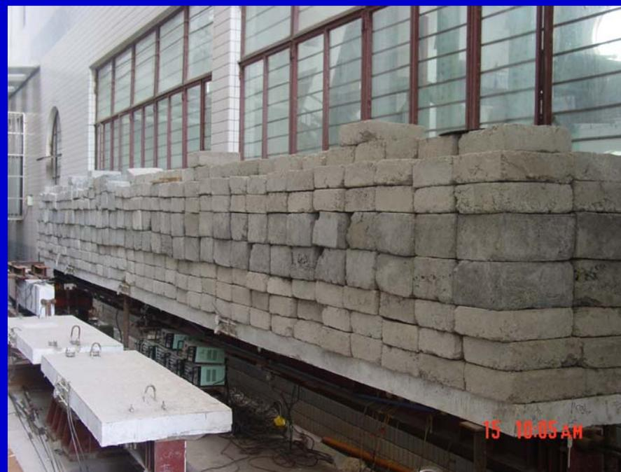
预应力钢-混凝土组合梁长期荷载试验
