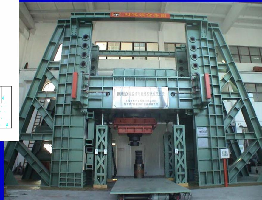
10000kN大型多功能试验机系统（同济大学建筑结构试验室）
