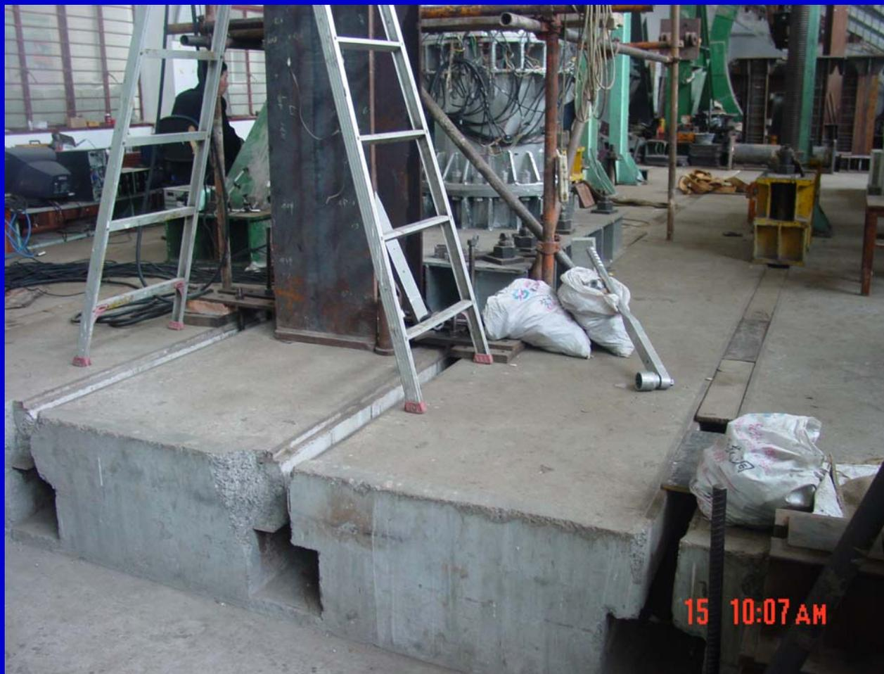
槽式试验台座，高出地面500mm（同济大学建筑结构试验室）
